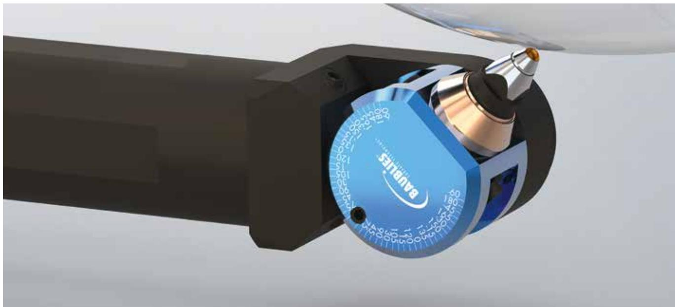
Diamant-Glättwerkzeuge erweitern das Einsatzspektrum zum Glätten und Verfestigen von Oberflächen gehärteter Werkstoffe bis über 60 HRC. Dabei gleitet ein Diamant über die zu glättende Fläche. Sobald die Fließgrenze des Werkstoffes überschritten wird, fließen die Profilspitzen an der
